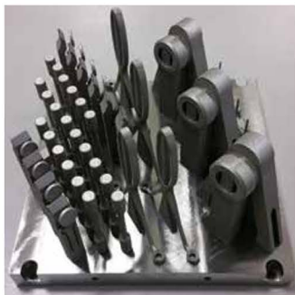
Die Stützstrukturen dieses additiv gefertigten Bauteils werden mit modernster Robotertechnologie auf einer Anlage von MartinMechanic entfernt. Bilder: Loll
