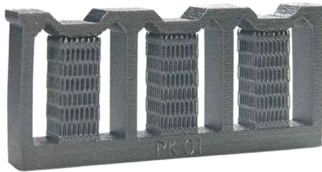
Musterbauteile mit Stützstrukturen werden vollautomatisch bearbeitet.
